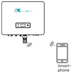
Smartphone verbindet sich direkt mit dem WLAN-Überwachungsgerät.
