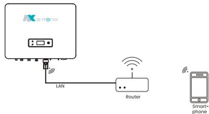
Smartphone und Überwachungsgerät werden gemeinsam mit dem Router verbunden.
