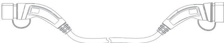
Abb. 6-5 Ladekabel mit zwei Anschlüssen (Anschluss Fall B)
